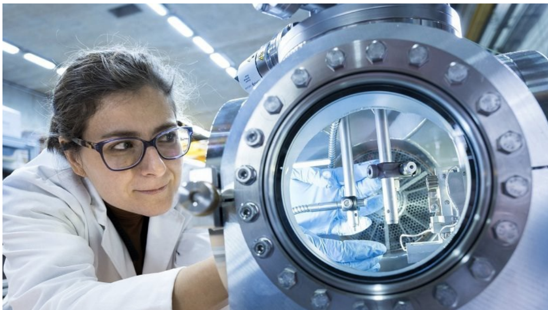
Physikerin Rita Graceffa an der Vakuummkammer für die Proben mit Viren, Zellen oder Bakterien, die mit Röntgenlaserblitzen untersucht werden
